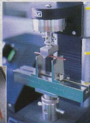
◀ 硬度検査機 この機械を使って砥石の硬度を調べる。同社の製品は圧倒的な柔軟性を示すという。
